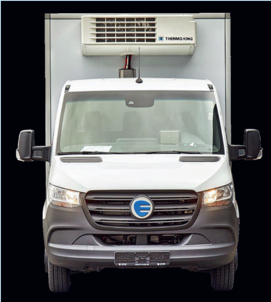
Von Diesel auf Strom: umgerüsteter Sprinter mit Orten-Kühlaufbau-Technik und sauberem E-Antrieb
