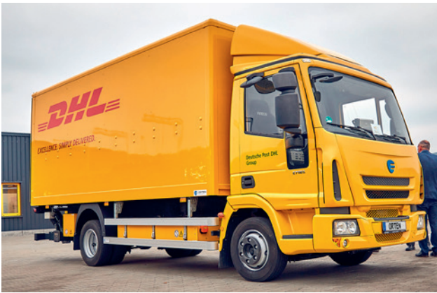
Im Einsatz für DHL: Verteiler-Lkw Orten E 75 EC. Der 7,5-Tonner baut auf einem Iveco Eurocargo auf, die Nutzlast beträgt zwei Tonnen, die Reichweite 100 Kilometer.
