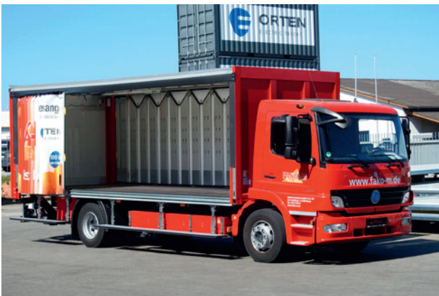
Verteiler-Stromer für die Getränke Logistik: Der E 150 AT ist bereits für den Getränkehändler Fako-M im Einsatz. Basis ist ein Atego 1524L, die Nutzlast des 15-Tonnners beträgt sechs Tonnen, die Reichweite bis zu 200 Kilometer.
