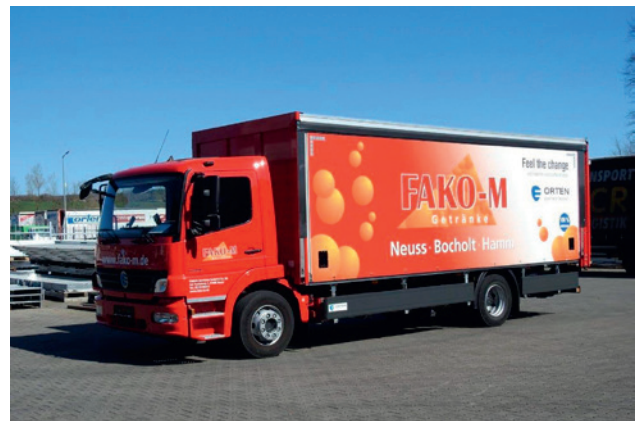
Verteiler-Stromer für die Getränke Logistik: Der E 150 AT ist bereits für den Getränkehändler Fako-M im Einsatz. Basis ist ein Atego 1524L, die Nutzlast des 15-Tonnners beträgt sechs Tonnen, die Reichweite bis zu 200 Kilometer.
