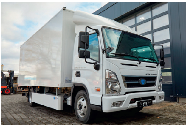
Noch ein Exot in Deutschland: Der Hyundai Mighty firmiert bei Orten Electric Trucks als Orten E 75 HM beziehungsweise ET Silent. Der 7,5-Tonner kann 2,65 Tonnen aufnehmen und bis zu 150 Kilometer ohne nachzuladen zurücklegen.
