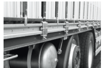
Laufschienen: stoßfest verzinkt
