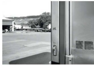
Edelstahl-Schnellspann-Hebelverschluss: vorne und hinten
